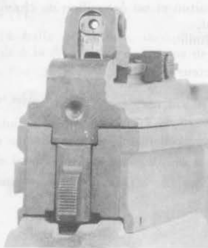
Fig. 6. — Oeillette réglable du F.S.A. 1949-56 [vue arrière droit]
