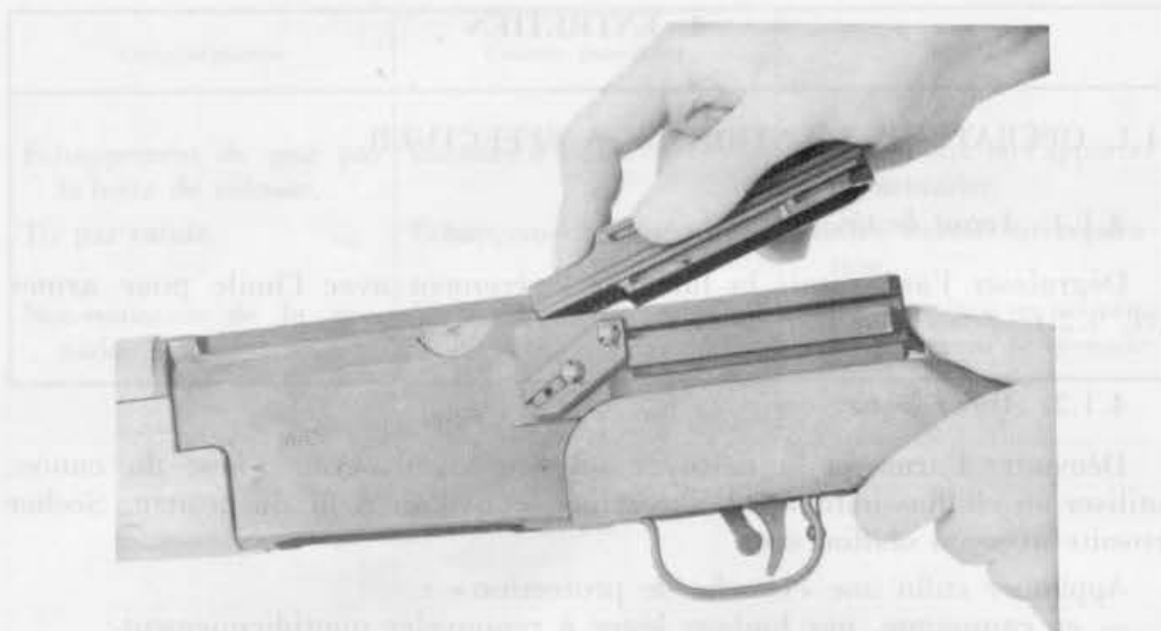
Fig. 13. — Démontage du couvre-culasse
