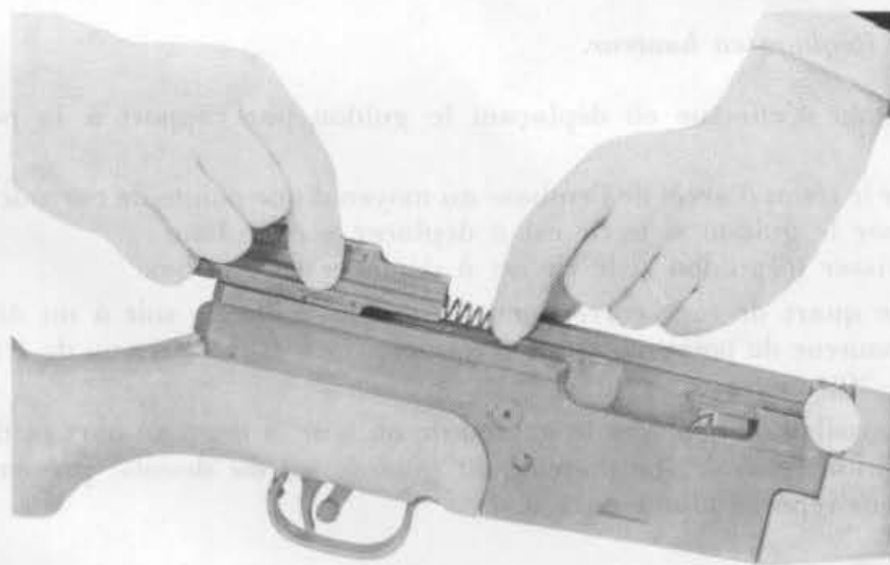
Fig. 15. — Remontage du couvre-culasse
