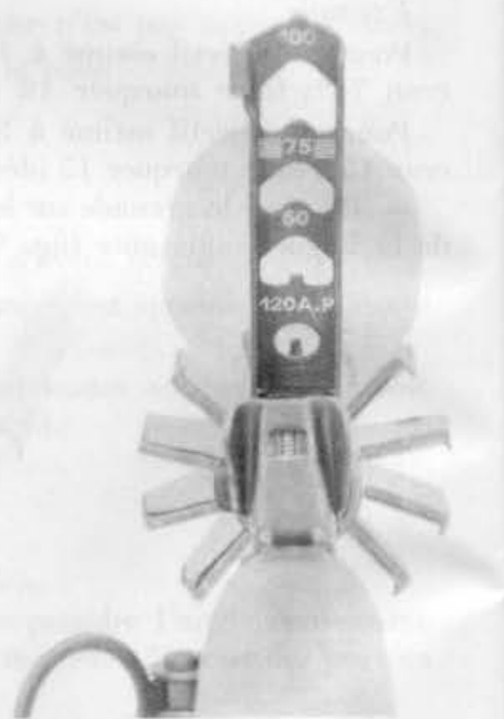
Fig. 11. — Visée correspondant à un tir tendu de grenade d'une portée de 75 mètres
